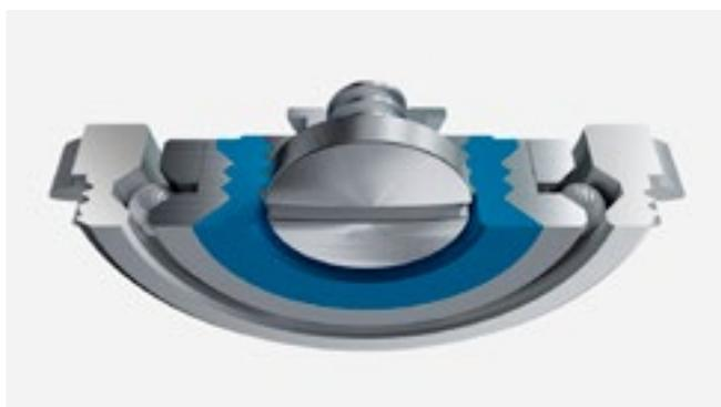
pagent à leur tour les vibrations sonores à l'intérieur de la boîte. Le roulement ActiVib propose un roulement à billes qui permet de filtrer efficacement la propagation des vibrations sonores générées par le roulement vers les autres composants du mouvement. A cette fin, ActiVib intègre un amortisseur réalisé en polymère élastomère spécialement développé pour cette application. Les tests réalisés en laboratoire ont montré une diminution des vibrations sonores de l'ordre de 10 dBA. ◦
